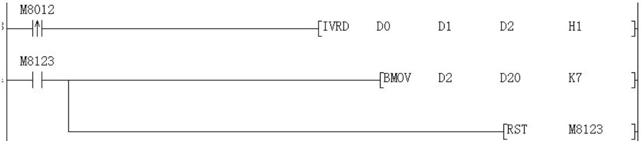
D0 为读取的站号(高 8 位)和命令码(低 8 位), 如 D0 的值为 H103, 就是站号 1, 读命令 3。D1 为要读取的数据地址, D2 为接收变频或仪表返回的数据首地址, 接收到数据, 如是通道 0, M8123 会置位。H1, 高 8 位通道, 低 8 位读取个数。通过通道 0 (485 通道), 读取 1 个数据。假如位 H101, 就是通过通道 (RS232 通道) 1 读取 1 个数据。
