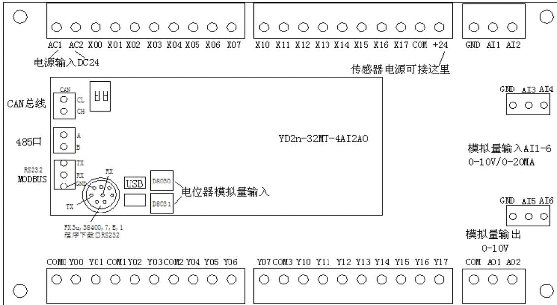
注:输入低电平有效,如输入点与COM接通,就是接通输入点,输入点为ON。
